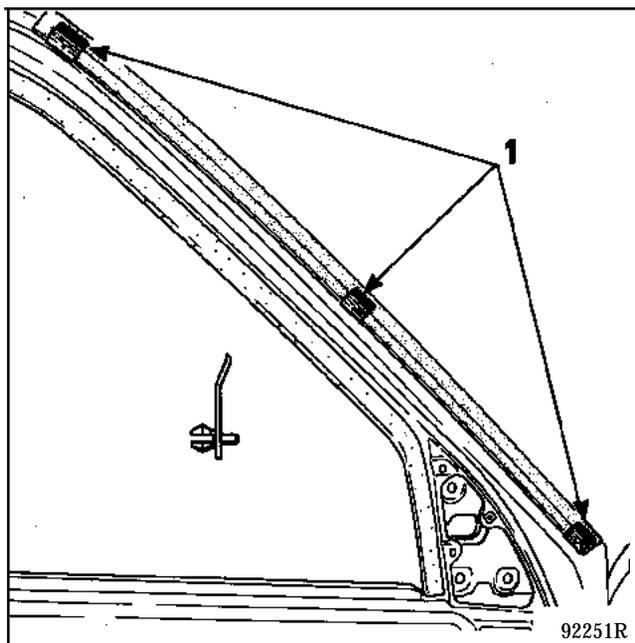
La dépose s'effectue en détériorant les agrafes, puis en décollant le joint au chalumeau à air chaud.
