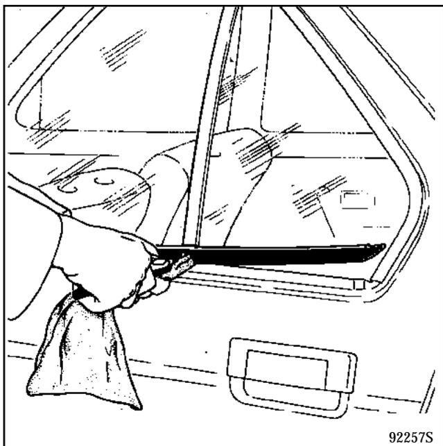
**ATTENTION** : pièce fragile, à l'aide d'un burin extra-plat protégé d'un chiffon, soulever tous les **10 cm** le lécheur.
